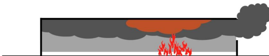
Fig 2. Incendio confinado infraventilado.
