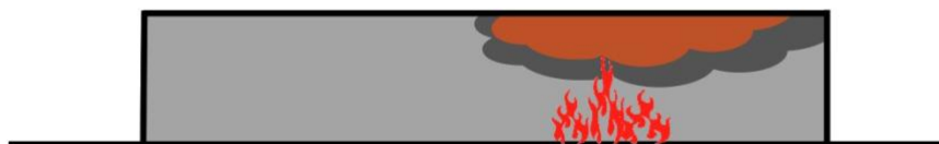
Fig 3. Incendio confinado no ventilado.
